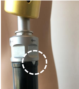
Abbildung 3 Das Rändelrad wird durch die Kerbe verriegelt
